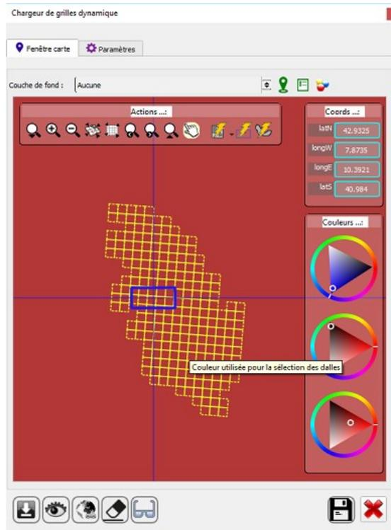
Pour rendre le paramétrage permanent, l'utilisateur doit enregistrer la configuration (bouton permanent de sauvegarde). Sans l'enregistrement, les réglages opérés ne valent que pour la session courante de QGIS.
